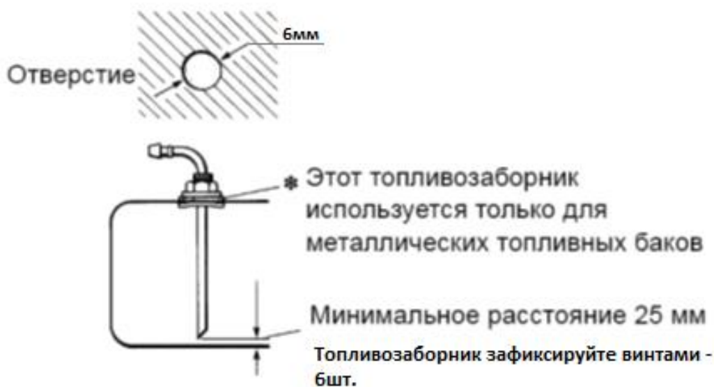
Рис.9 Пример монтажа грузового топливного заборника
