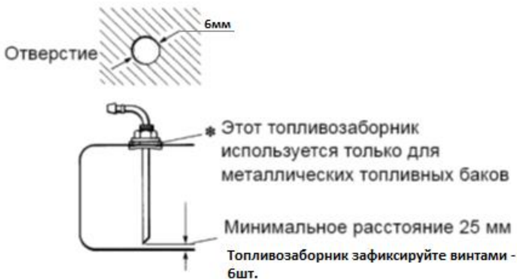
Рис.9 Пример монтажа грузового топливного заборника
