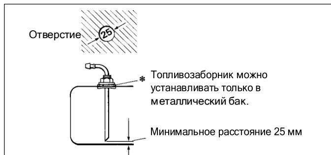
Рис. 9: Топливозаборник А100 из бака (грузовой)
